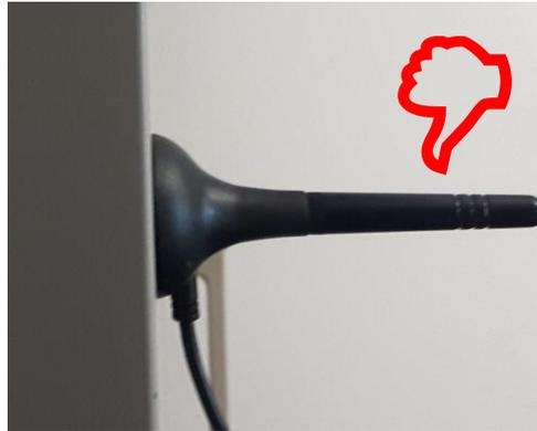
Dieser Hinweis gilt vor allem für längliche Antennenbauformen, sogenannte Stabantennen. Bei anderen Bauformen ist die übliche Ausrichtung auf dem Produktfoto ersichtlich oder in der Artikelbeschreibung genannt.
